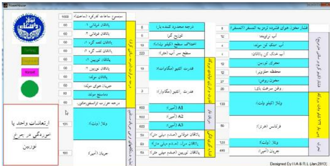
شکل 29 - صفحه GUI در حالت نمایش عیب در تجهیزات برای مثال عیب در ارتعاشات واحد یا خوردگی در چرخ توربین
